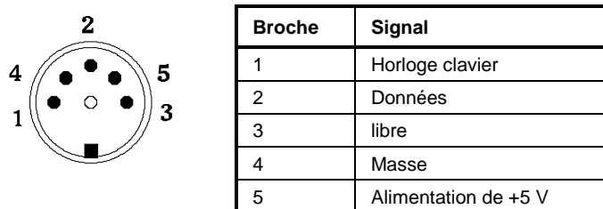
Fig. 8-9 Brochage de la prise KEYBOARD
